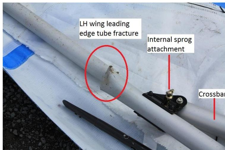
**Figure 13: Fracture N°3**
