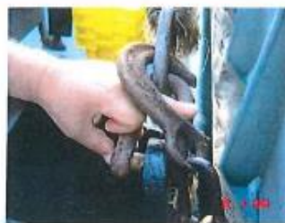
De kettinghaak die een gevaar vormt bij op spanning komen.
