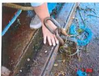
Klemmingsgevaar tussen schakels en sluitingen.
